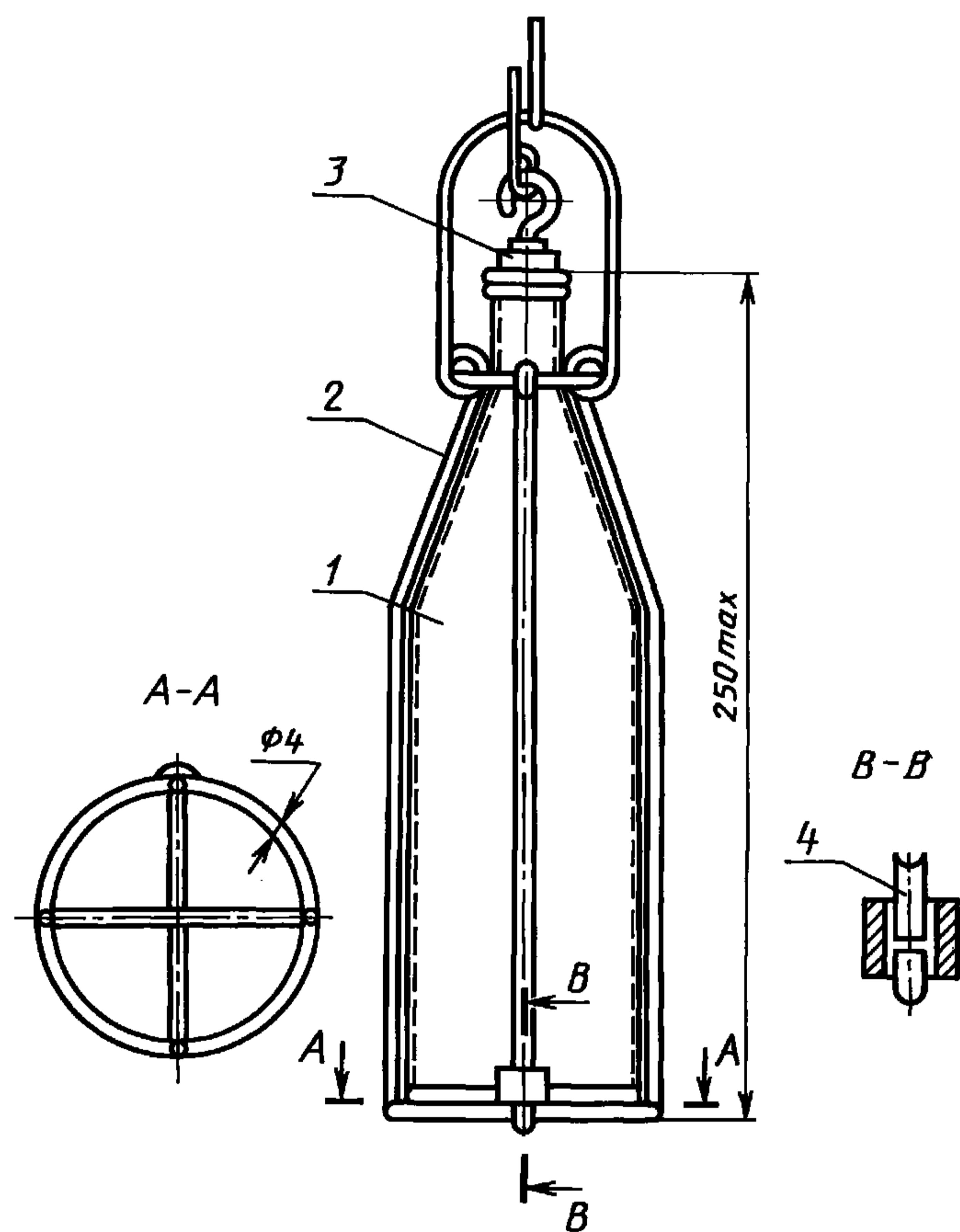
1 — бутылка; 2 — металлический каркас; 3 — пробка; 4 — замок
