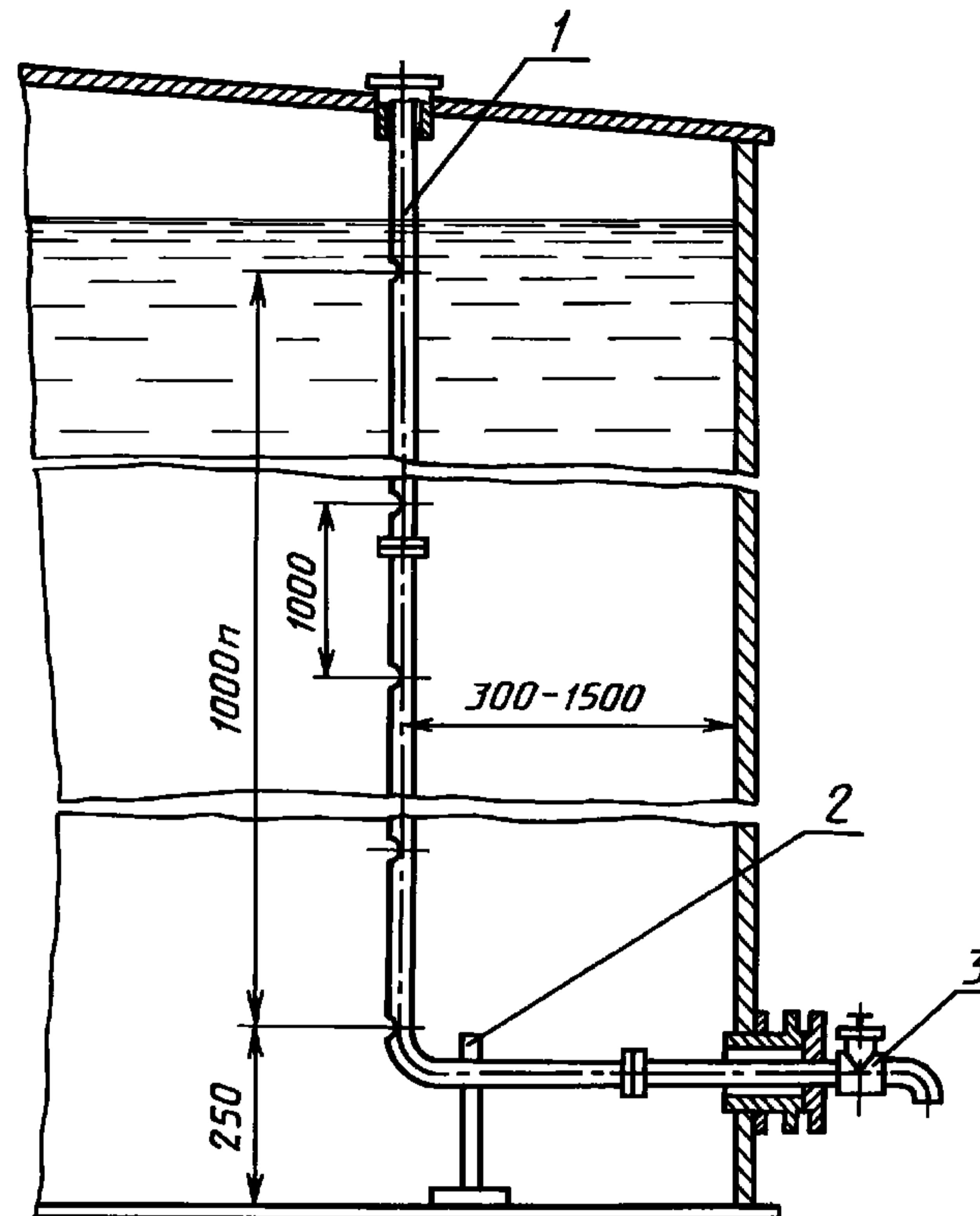
1 — перфорированная заборная трубка; 2 — опорная стойка; 3 — кран
