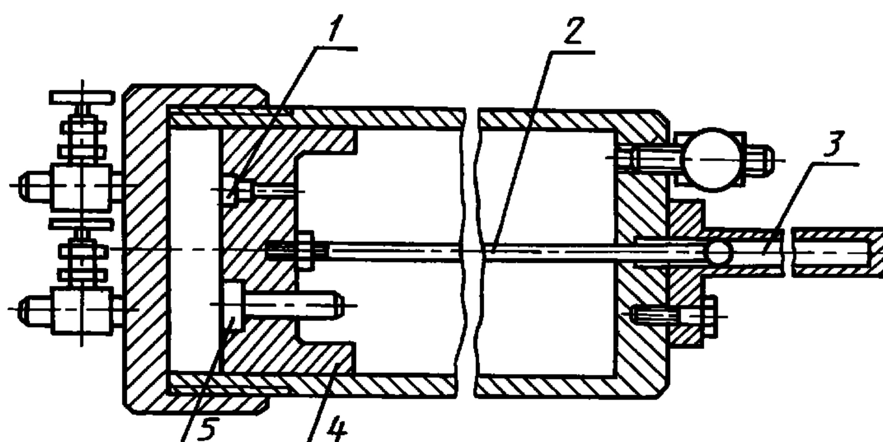
1 — предохранительный клапан; 2 — шток поршня; 3 — указатель положения поршня; 4 — поршень;
