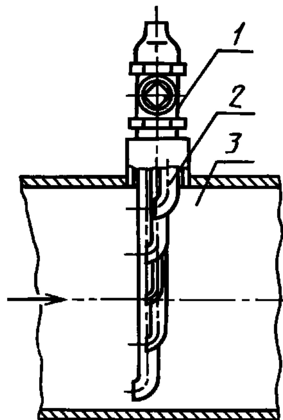
1 — вентиль; 2 — пробозаборная трубка; 3 — трубопровод
