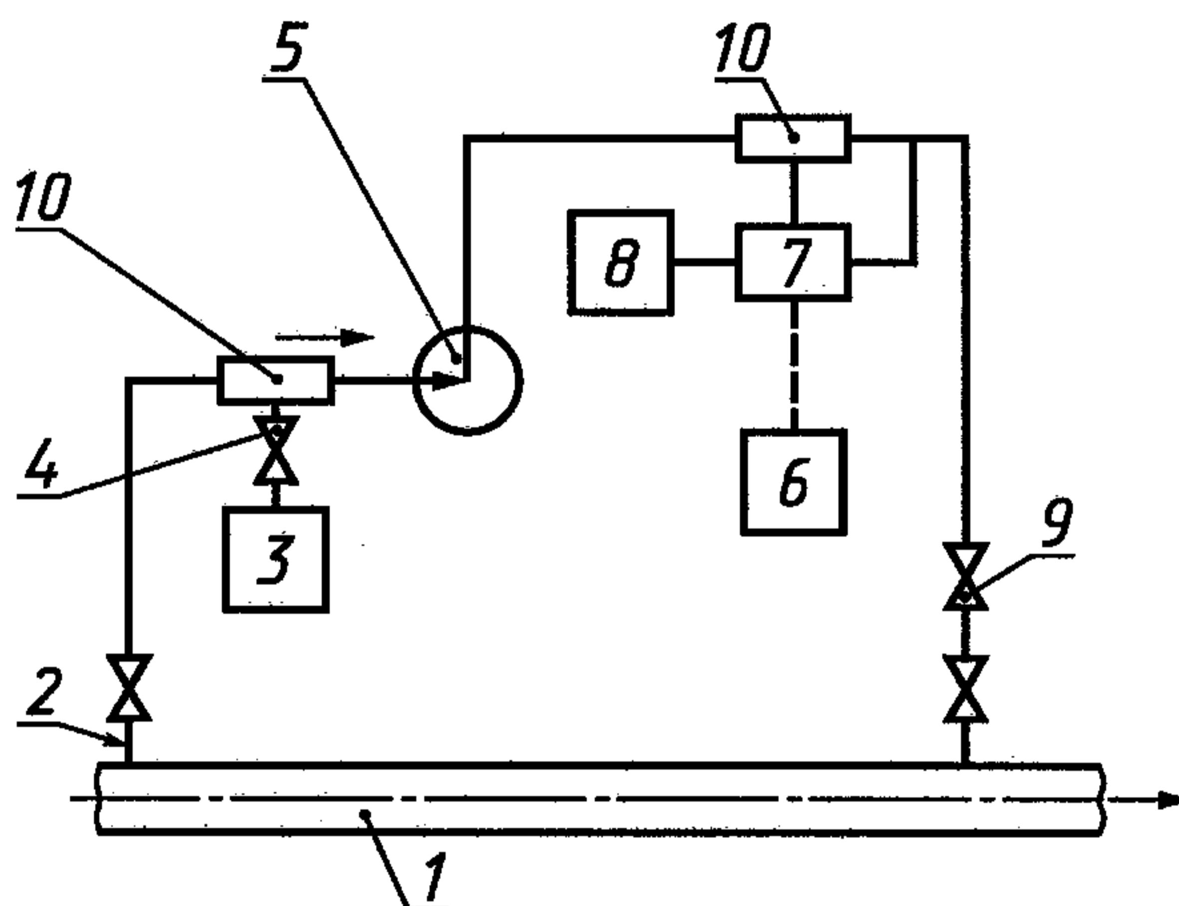
1 — трубопровод; 2 — пробозаборное устройство; 3, 8 — пробозаборники; 4 — кран для ручного отбора проб; 5 — насос;
