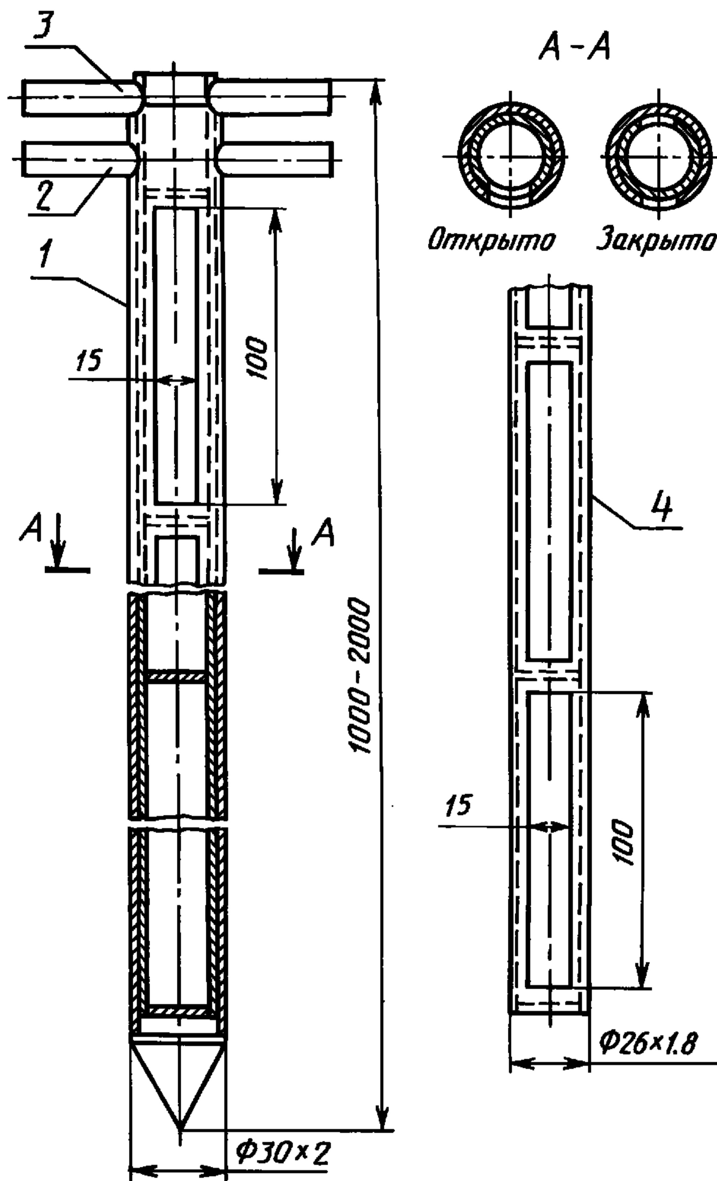
1 — наружная трубка; 2, 3 — ручки; 4 — внутренняя трубка
