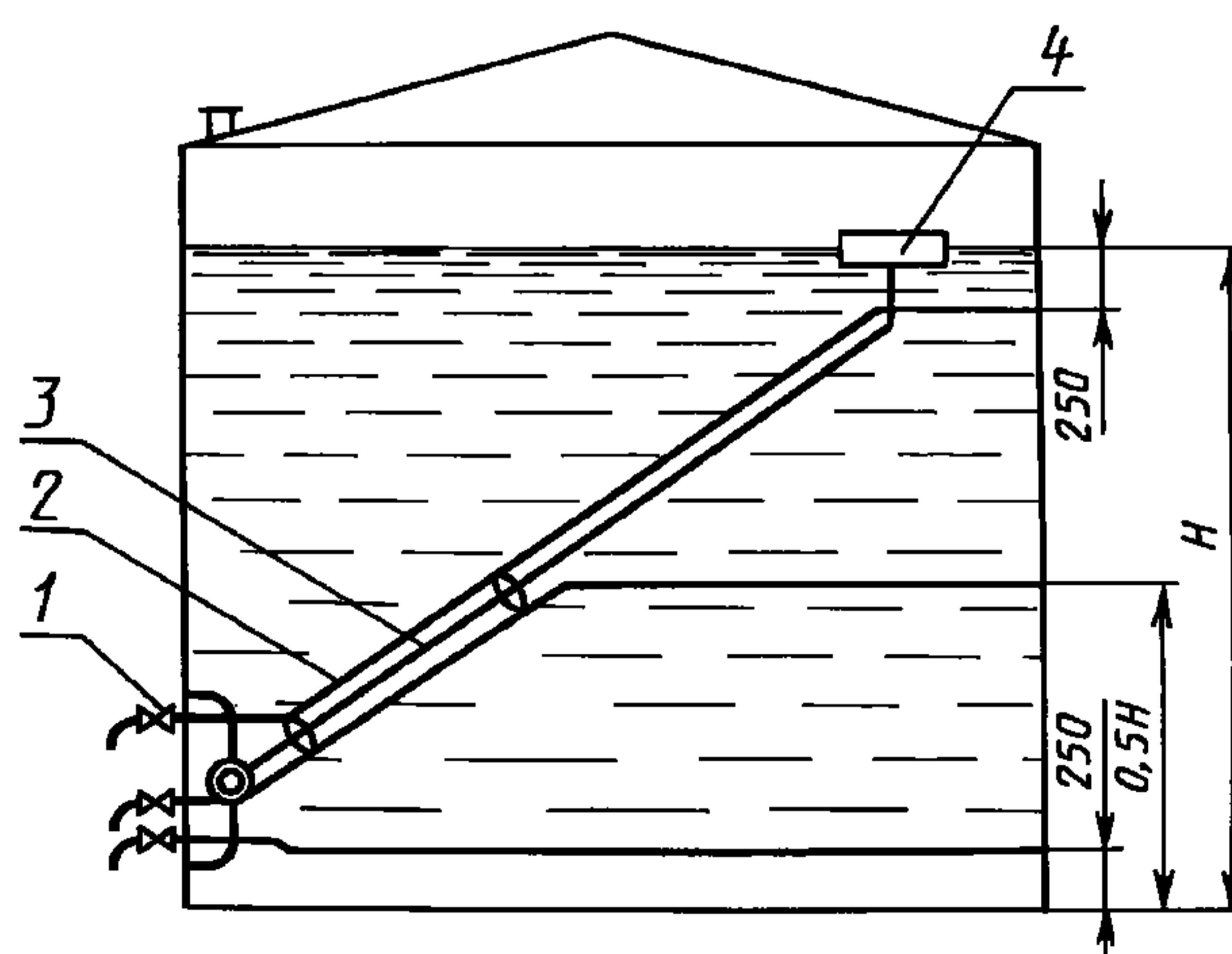
1 — кран; 2 — пробозаборные трубы; 3 — несущий рычаг; 4 — поплавок
